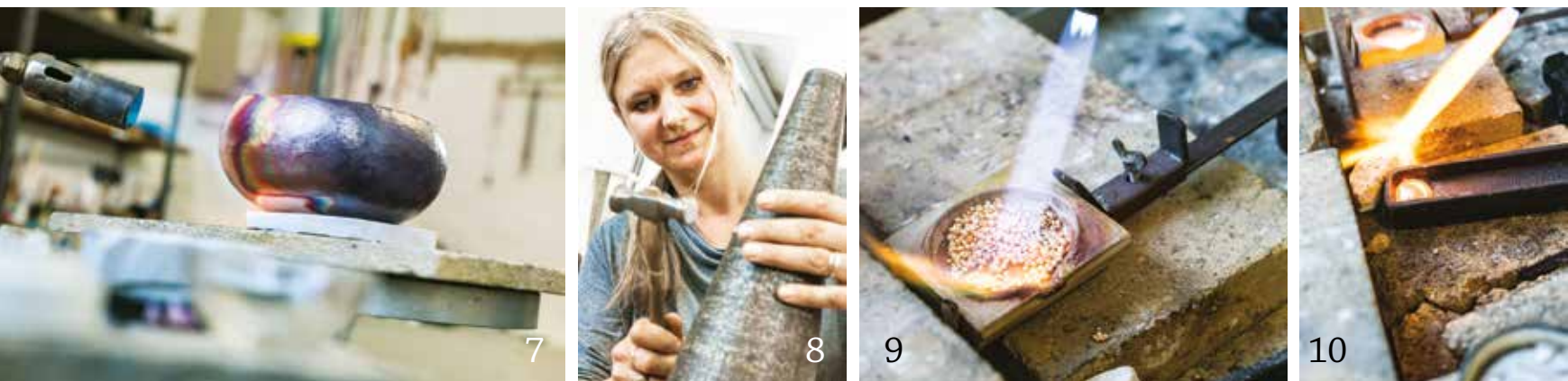
7 - 10 Glühen, Schmieden, Schmelzen und Gießen sind bei der Metallgestaltung typische Techniken.
